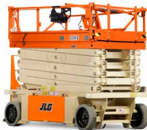
10RS in Transport Konfiguration mit abgeklappten Geländer
